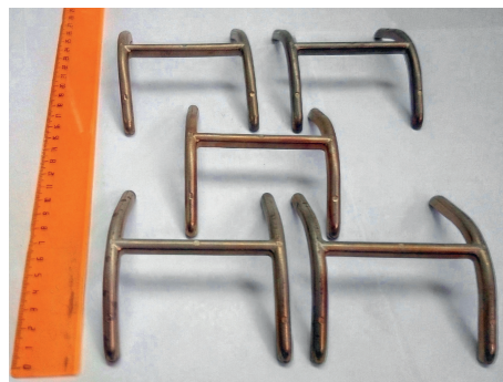
Рис. 1. Детали поглощающего аппарата сцепки железнодорожных вагонов
