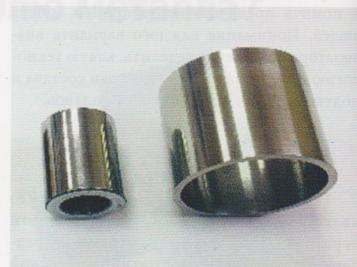
Рис. 3. Подшипники нижней и верхней головки шатуна из нового композиционного материала на основе железа
