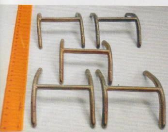
Рис. 1. Антифрикционные элементы поглощающего аппарата сцепки железнодорожных вагонов
